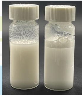
微米級氣凝膠 奈米矽片分散劑分散
